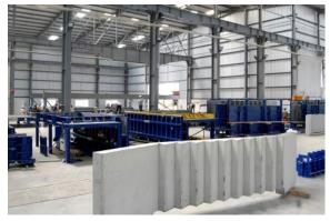
In Indien werden neben Wand- und Deckenelementen auch komplexe Sonderbauteile wie Fertigteiltreppen gefertigt. Die Schalung übernimmt eine stationäre Lösung von Nuspl.
