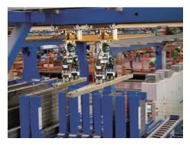
Moderne Magazinier- und Schalungsroboter arbeiten mit hohen Taktzeiten.
