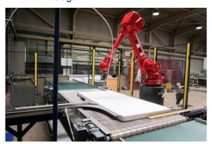
Mit einem Wasserstrahl von 4.000 bar und höchster Präzision bringt die ISO-MATIC 2.0 verschiedene Isoliermaterialien in die gewünschte Form.
