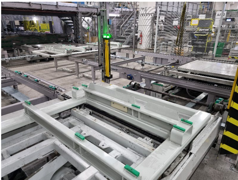
Figura 2 – Transportador de corrente cruzada ampliado Juntamente com a Vollert, o transportador de cadeia cruzada existente foi, portanto, ampliado em quatro estações reserva adicionais. Isto cria capacidade para futuros aumentos de desempenho, uma vez que vários skids podem ser armazenados em reserva antes e depois do local de trabalho.
