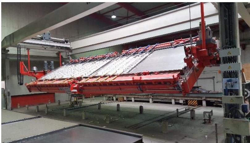
Figura 8 O novo sistema de braços tensores da Voller traz uma nítida vantagem de custos com relação à tecnologia de fixação nos paletes de giro usada até agora.
