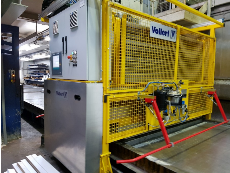
Figura 3 Na MÚVA Beton em Holzminden, um dispositivo MRP, recém-instalado, não só recolhe as travessas longitudinais do palete de giro e as carrega, mas, ao mesmo tempo, também limpa a superfície do palete.
