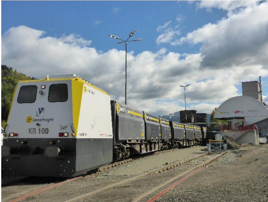
Figura 3 Inclusive nos equipamentos de descarga de coque pela voestalpine, em Donawitz bei Loeben, Áustria, o robô de manobra KR 100 da Vollert é peça central no conceito de logística.
