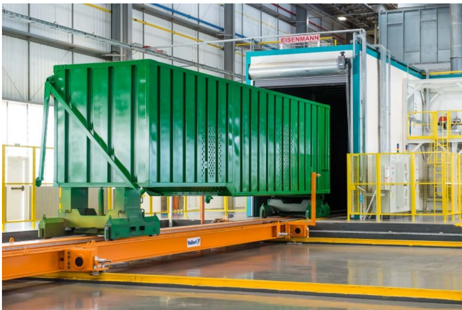
Figura 4 Uma segunda plataforma de transferência para cargas pesadas é responsável pela saída da cabine de secagem e distribuição das carretas e vagões, nas duas linhas de montagem paralelas, onde são então montados os componentes rodantes.
