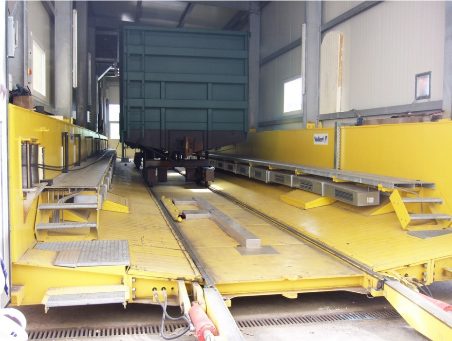
Figura 3 Totalmente revestidas y caldeadas, las plataformas de transferencia para cargas pesadas de Vollert proporcionan una protección óptima contra la intemperie, en el revestimiento de vagones de ferrocarril, en la nueva planta de TVSZ en Rusia.
