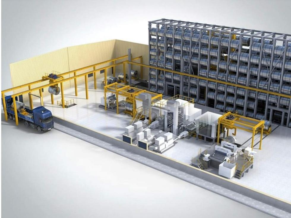
Hydro Aluminium Rolled Products GmbH moderniza su planta laminadora en Grevenbroich para una mayor calidad de sus productos. Con un transporte completamente automático así como la carga y descarga del camión, Vollert Anlagenbau garantiza el manejo seguro de las delicadas bobinas. El nuevo almacén de gran altura ofrece espacio para 336 bobinas de aluminio con un peso total de 4.000 toneladas. Ilustración: Hydro.
