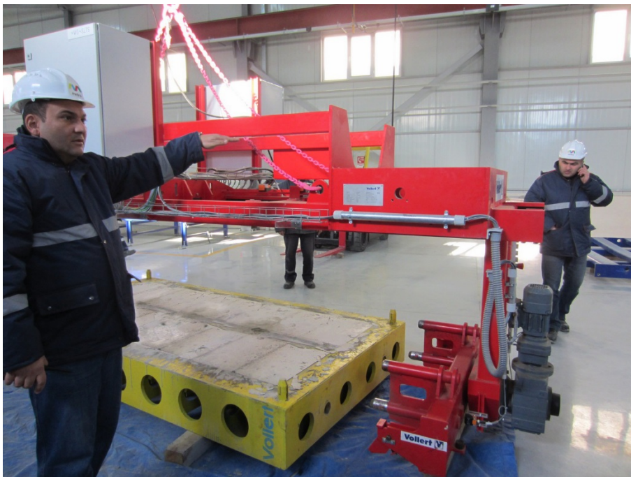
Figura 4 Con un dispositivo de volteo se giran los bloques de traviesas y se desmoldean con un disco balancín de golpe.
