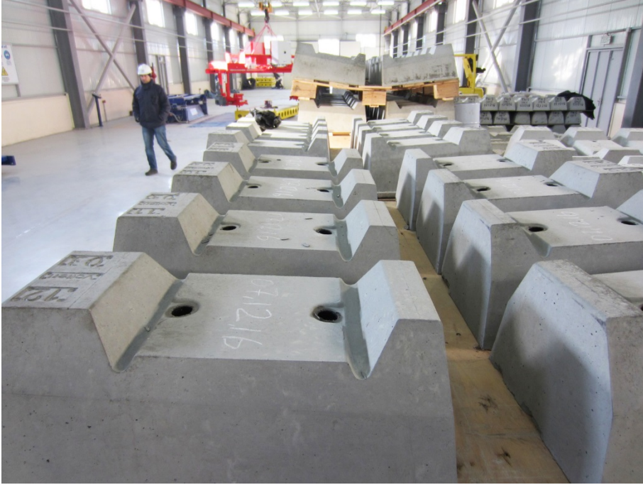
Figura 5 En la nueva fábrica de traviesas de hormigón, con 20 moldes se pueden fabricar hasta 30 000 traviesas de hormigón al año.
