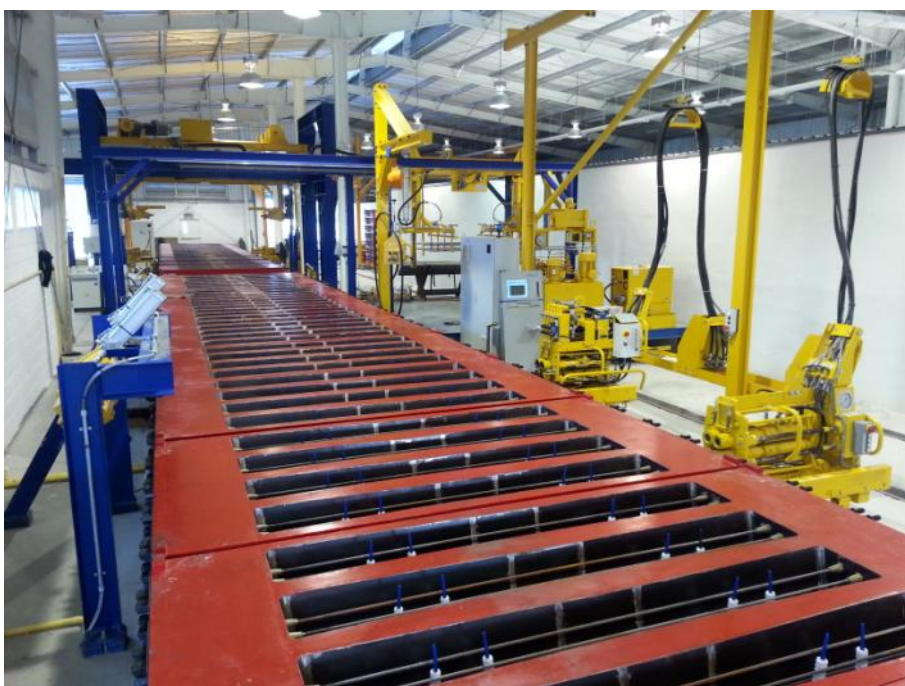
Fig. 4: Тросы натягиваются полуавтоматическим домкратом с усилием натяжения 460 кН
