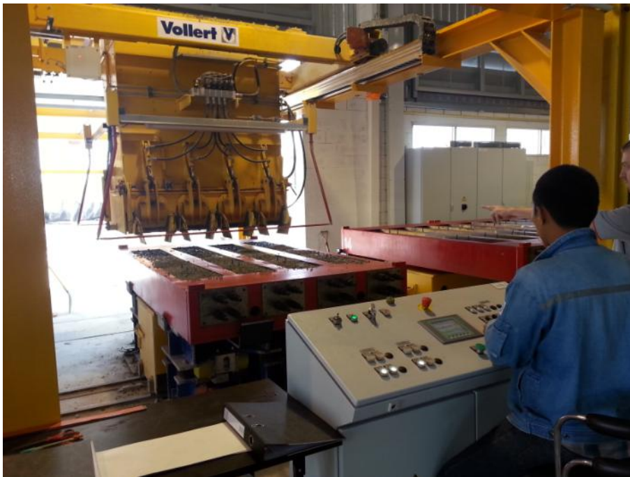
Fig. 5: Полуавтоматический бетонораздатчик перемещается по мостовой конструкции между расположенной снаружи БСУ и станцией бетонирования в цехе
