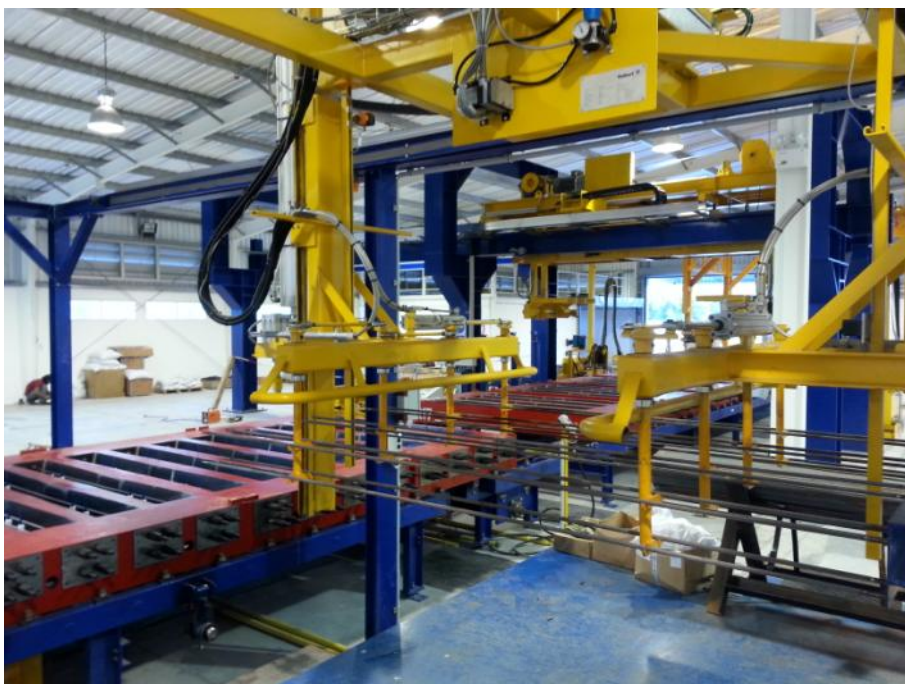
Fig. 2: Робот для укладки арматуры устанавливает подготовленные тросы в форму
