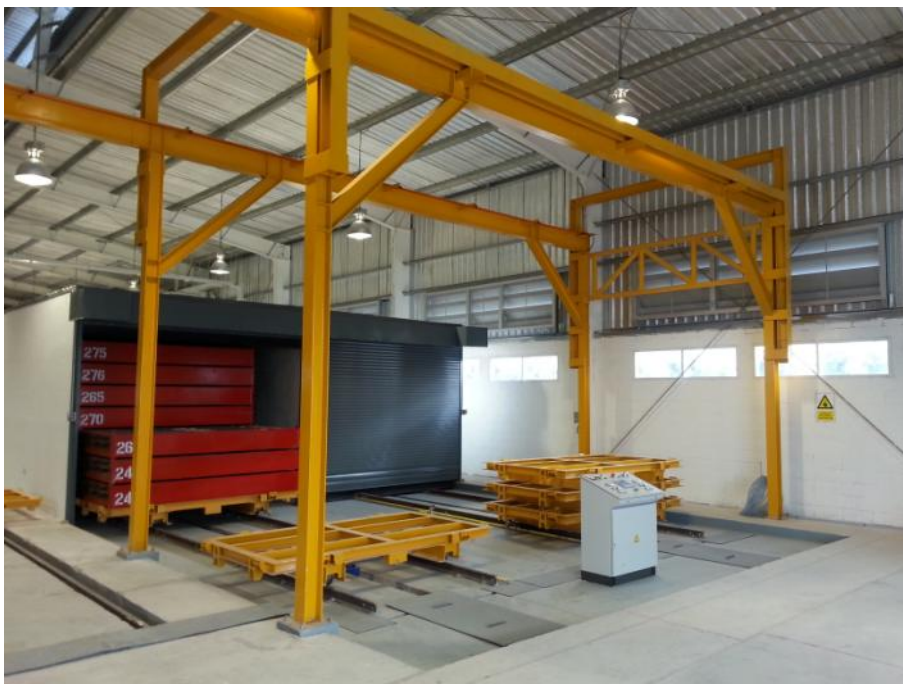
Fig. 7: Поперечные тележки с заданным тактом проезжают по параллельным путям через теплоизоляционную камеру выдержки
