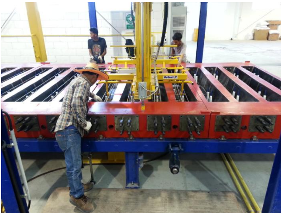
Fig. 3: Отдельные натяжные тросы со смонтированными зажимными и анкерными болтами крепят в форме вручную
