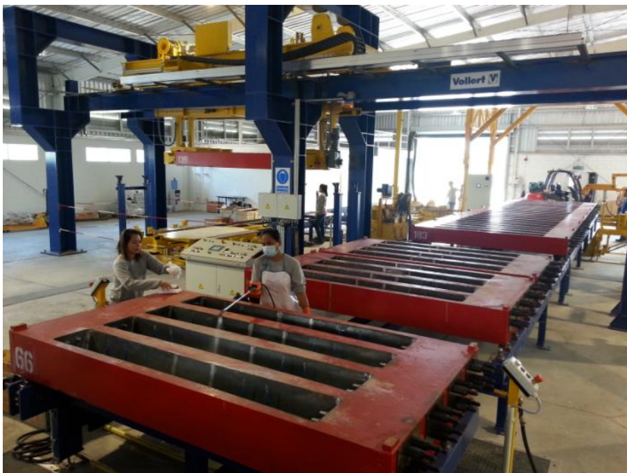
Fig. 1: После распалубки четырехсекционные формы для шпал очищаются и смазываются перед установкой дюбелей для последующего крепления шин
