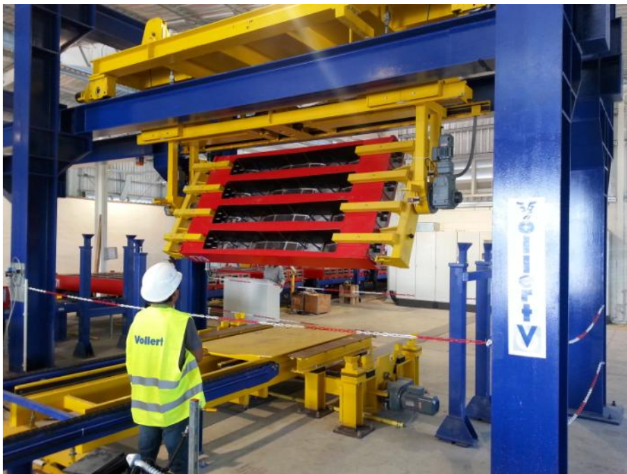
Fig. 10: Uma travessa de viragem desloca o molde de concreto desmoldado para uma área de saída, vira-o a 180 graus, antes de um dispositivo de elevação elétrico efetuar o processo de desmoldagem.
