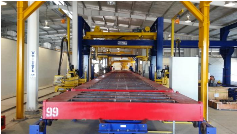
Fig. 9: Mediante uma estação de desmoldagem parcialmente automatizada, seguidamente é iniciado o processo de retensionamento.
