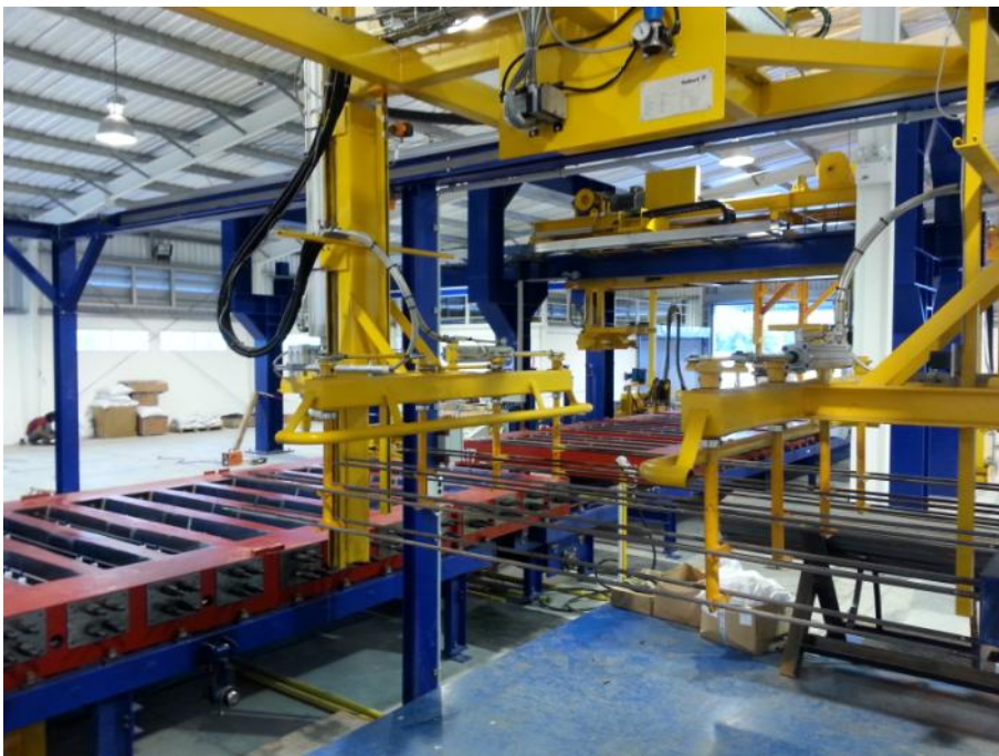
Fig. 2: Um manipulador de colocação de armaduras insere os cabos tensores preparados no molde de concreto.
