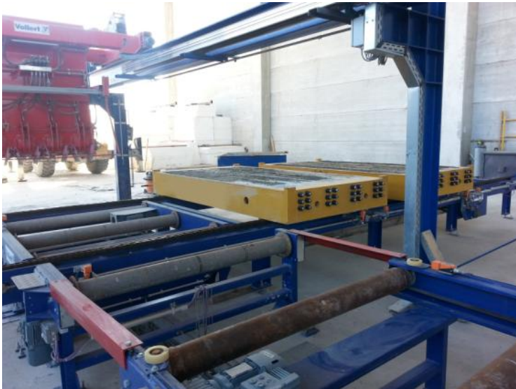
Fig. 4: El distribuidor de concreto semiautomatizado con tornillo sin fin y de accionamiento eléctrico llena los moldes con exacta precisión
