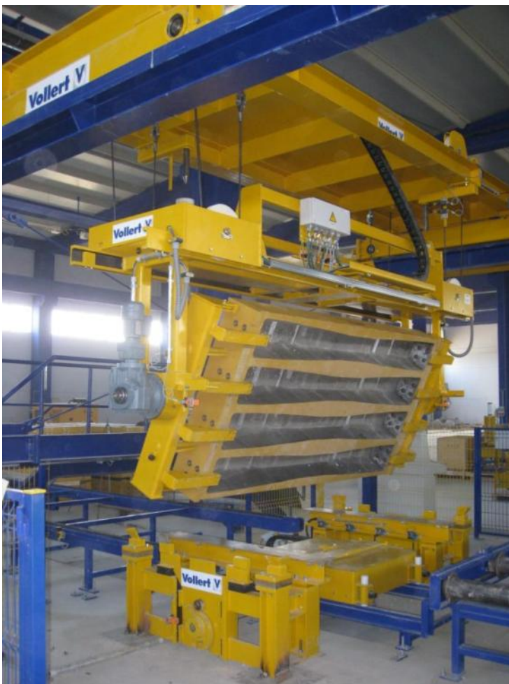
Fig 6: С помощью поворотного механизма формы поворачивают на 180 градусов
