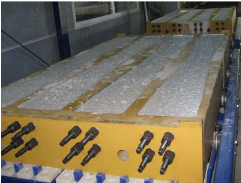
Fig 4: Форма после процесса бетонирования
