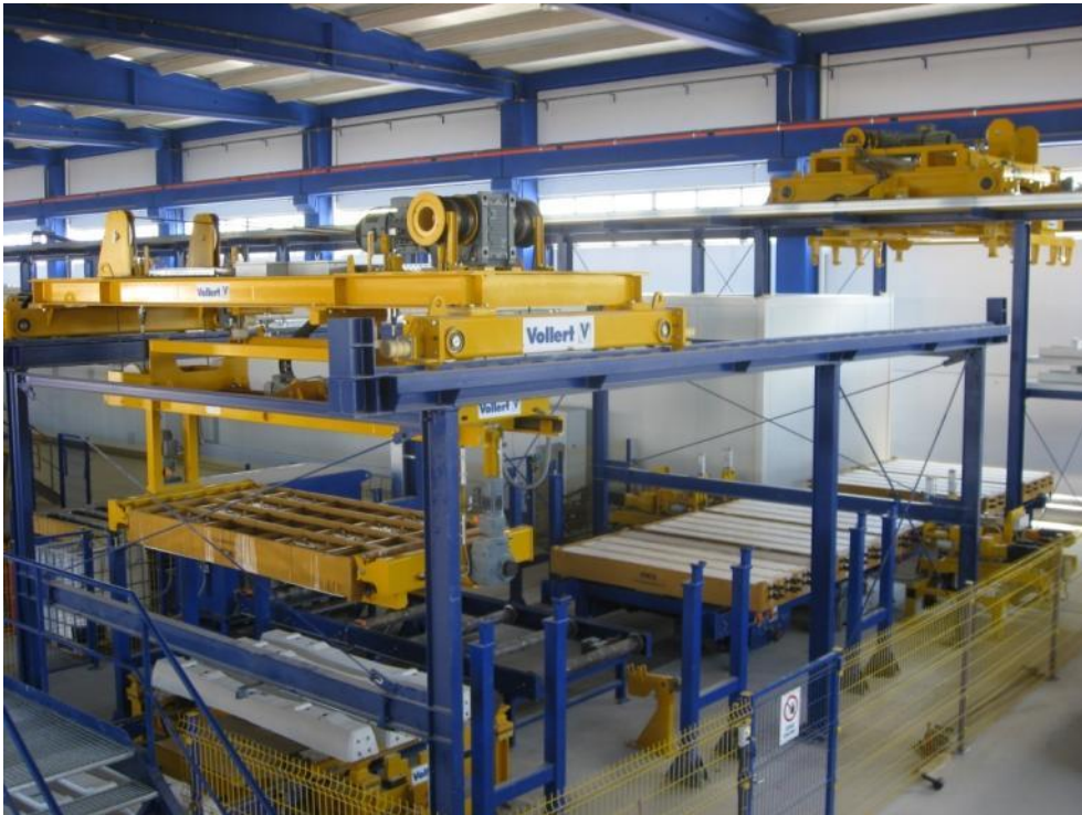
Abb. 7: Entschalen der Schwellenform
