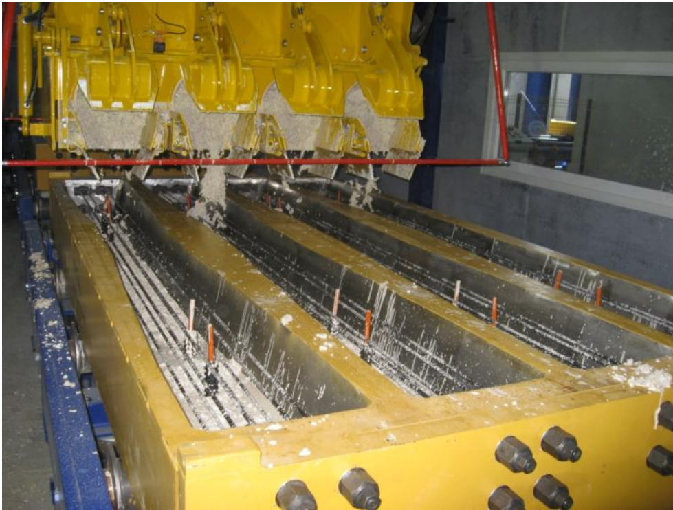
Abb. 3: Gleichzeitig zur Befüllung erfolgt die Verdichtung mit einer hochfrequenten Rüttelstation
