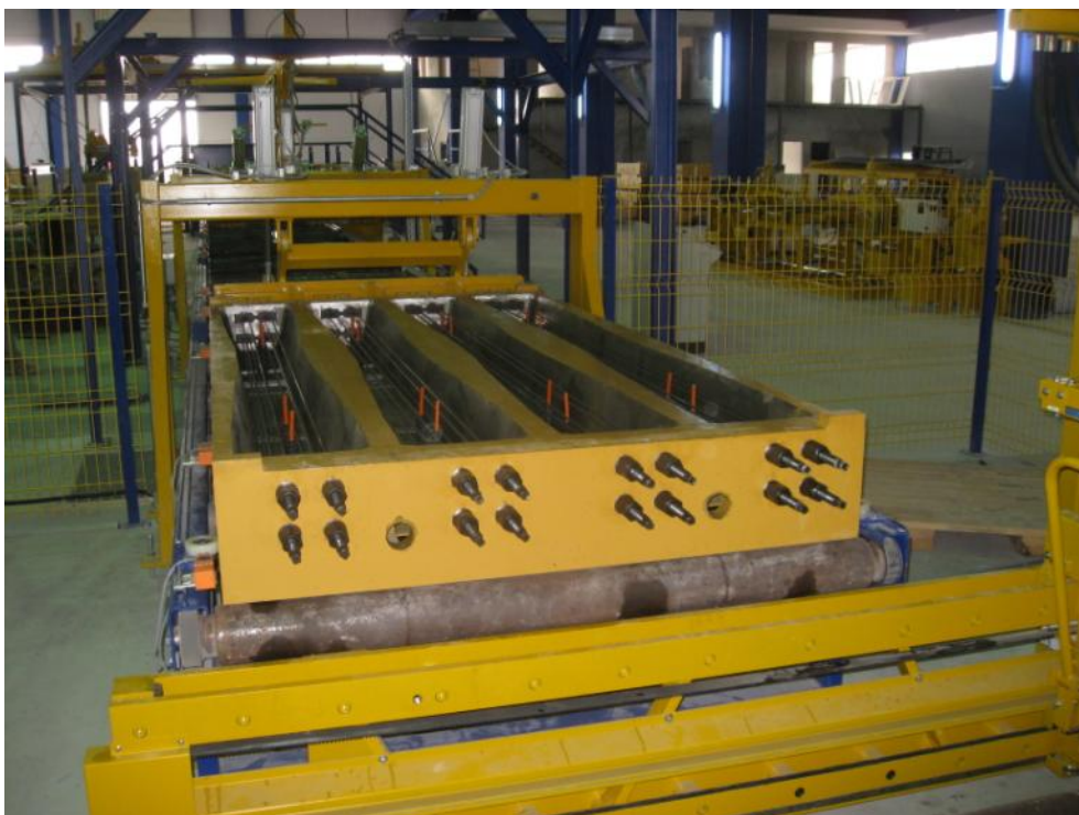
Abb. 2: Schwellenform nach dem Einbringen der Bewehrung
