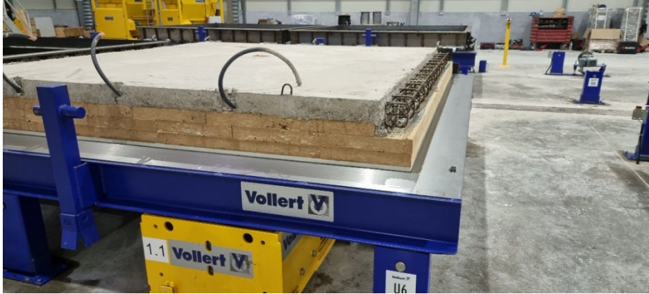
Photo 7 : L'isolation des murs sandwich emprunte également de nouvelles voies pour réduire l'empreinte écologique.
