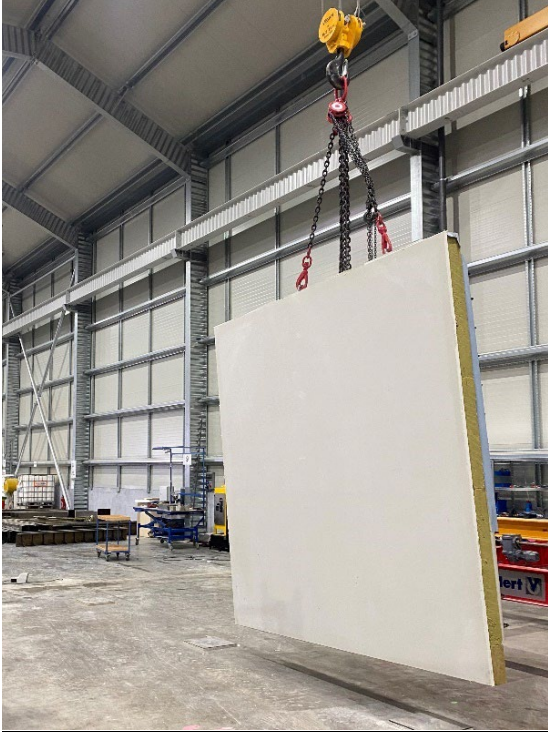
Photo 9 : Ainsi, la façade extérieure en béton à haute résistance ne fait que 25 mm d'épaisseur.
