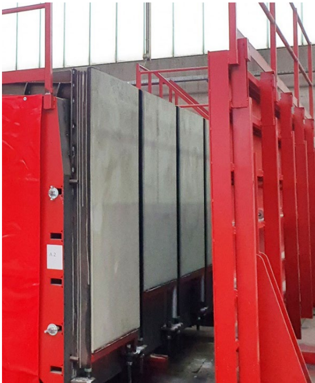
Bild 4: Für eine hervorragende Oberflächenqualität werden die Mauersteine stehend überkopf produziert.
