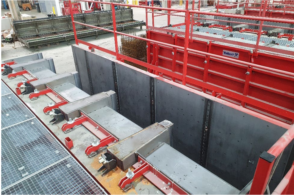
Bild 3: Die Zwischenabsteller sind bedingt durch die Fasengeometrie geteilt.
