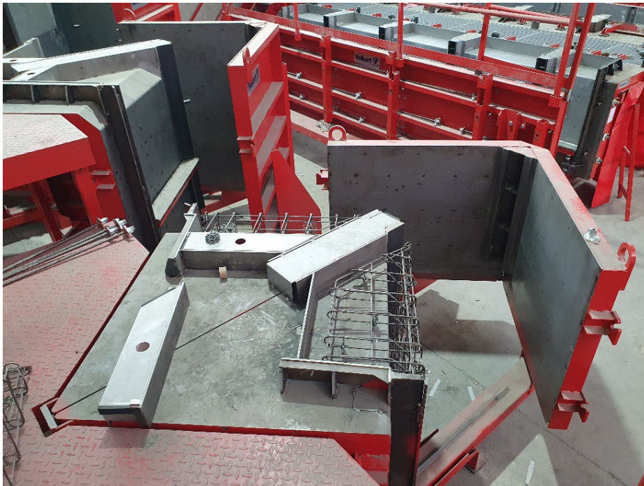
Bild 6: Die L-förmige Seitenschalung wird pneumatisch diagonal verfahren und ermöglicht so einen sicheren Entschalvorgang.
