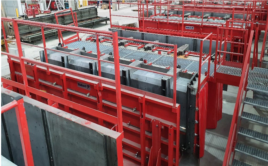
Bild 1: Duplex-Reihenschalungen bieten eine äußerst wirtschaftliche Lösung für die Mauersteinproduktion.
