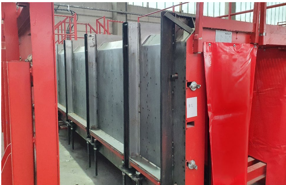
Bild 2: In jeder Reihenschalung können 8 L-Elemente mit einer Steinbreite von 99 cm sowie je 2 L-Elemente mit einer Steinbreite von 49 cm gefertigt werden.
