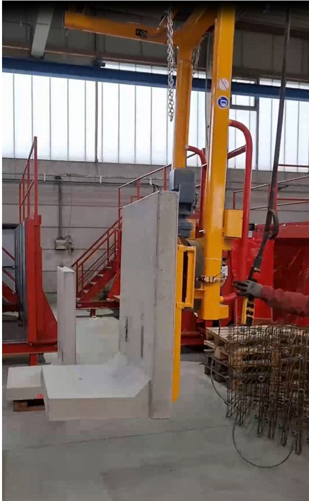
Bild 7: Um die L-Winkel-Mauersteine sicher nach dem Entschalen aus der Schalungsform abzuheben, ist eine krangeführte Vakuum-Abhebetraverse ideal.
