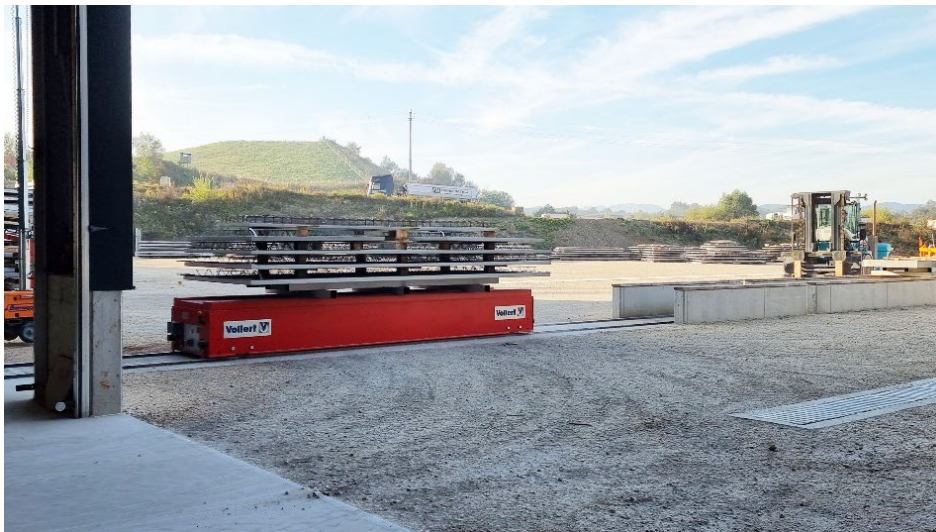
Photo 10 : Le transport de piles de prédalles vers l'extérieur est assuré par un chariot de sortie.
