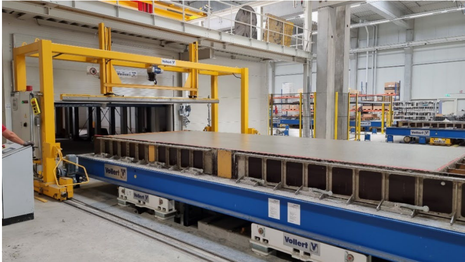
Фото 6: Вибростанция SMART COMPACT обеспечивает оптимальное уплотнение бетона после процесса бетонирования.
