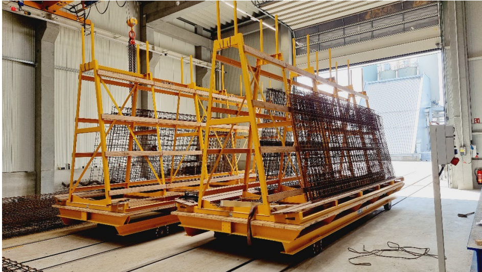
Фото 10: Транспортные тележки подают арматурные маты.
