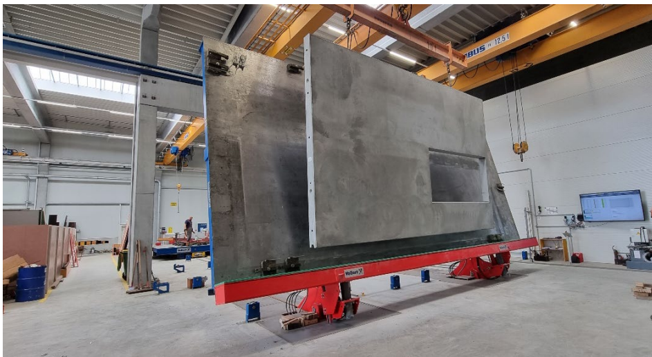
Фото 11: Вертикальный подъем стен осуществляется с помощью высокопроизводительного кантователя VArgo TILT.
