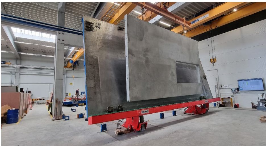
Photo 11 : Le soulèvement vertical des murs est assuré par une station de basculement haute performance VARIO TILT.
