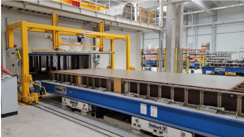
Photo 6 : Une station de secouage SMART COMPACT assure un compactage optimal du béton après le bétonnage.
