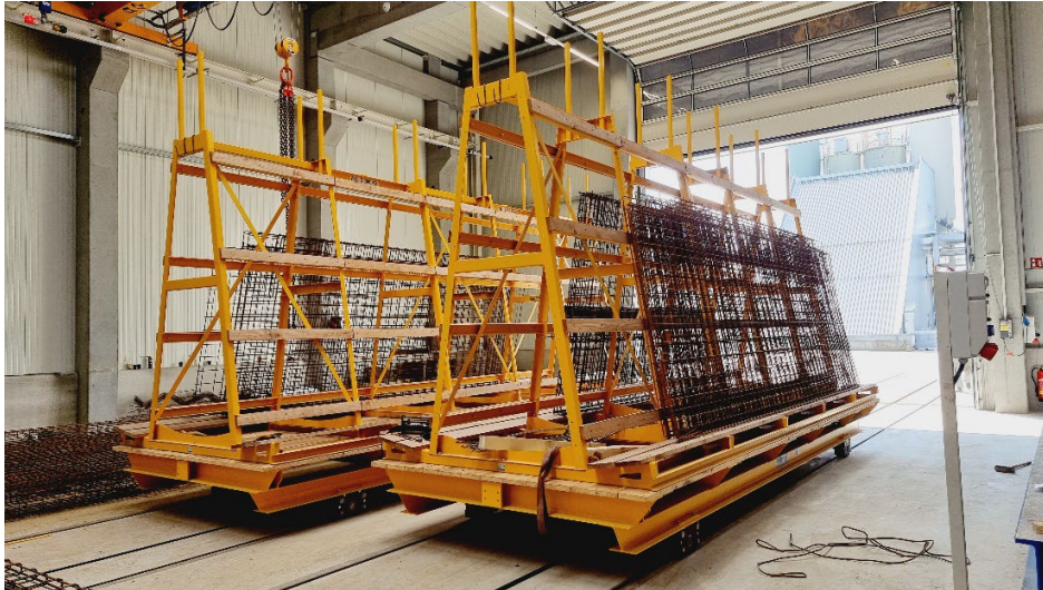
Photo 10 : Les chevalet de transport sont utilisés pour les treillis d'armature.
