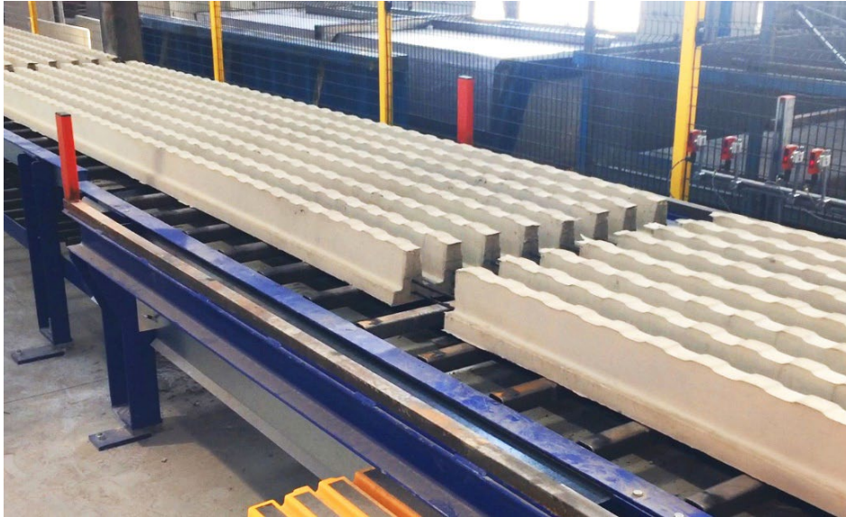
Figura 7 Após um processo de giro de 180°, as vigas de concreto protendido repousam sobre um transportador de corrente para posterior transporte até a área de corte.
