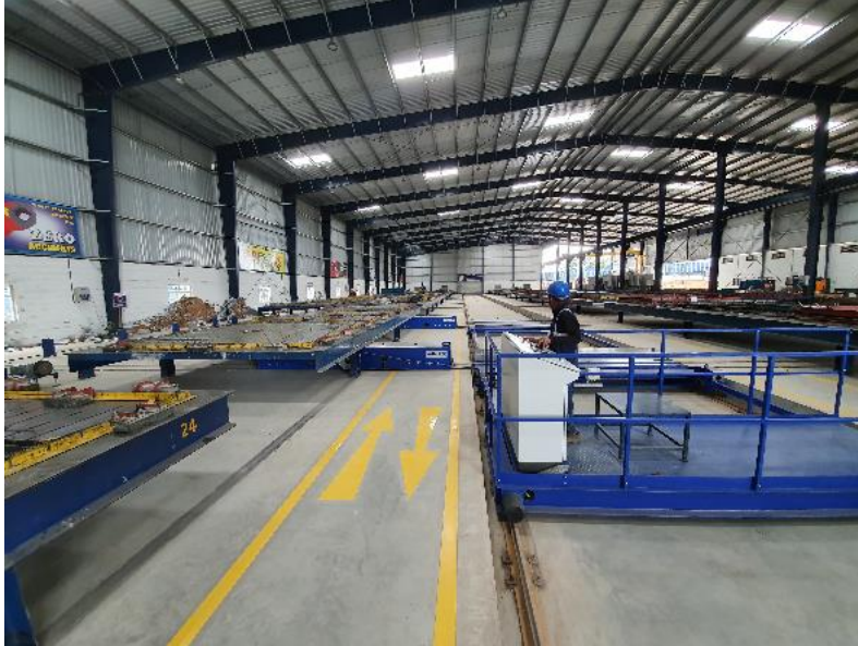
Figura 5 Una plataforma transbordadora central VARIO SHIFT es el corazón del sistema y hace que los procesos del sistema sean lo más flexibles posible.
