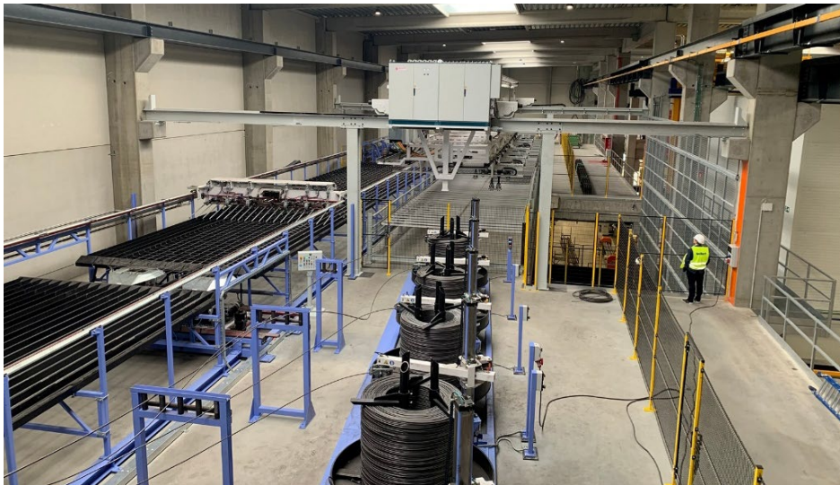
Figura 7 + 8 Toda la preparación de refuerzo totalmente automatizada tiene lugar en un nivel intermedio superior.
