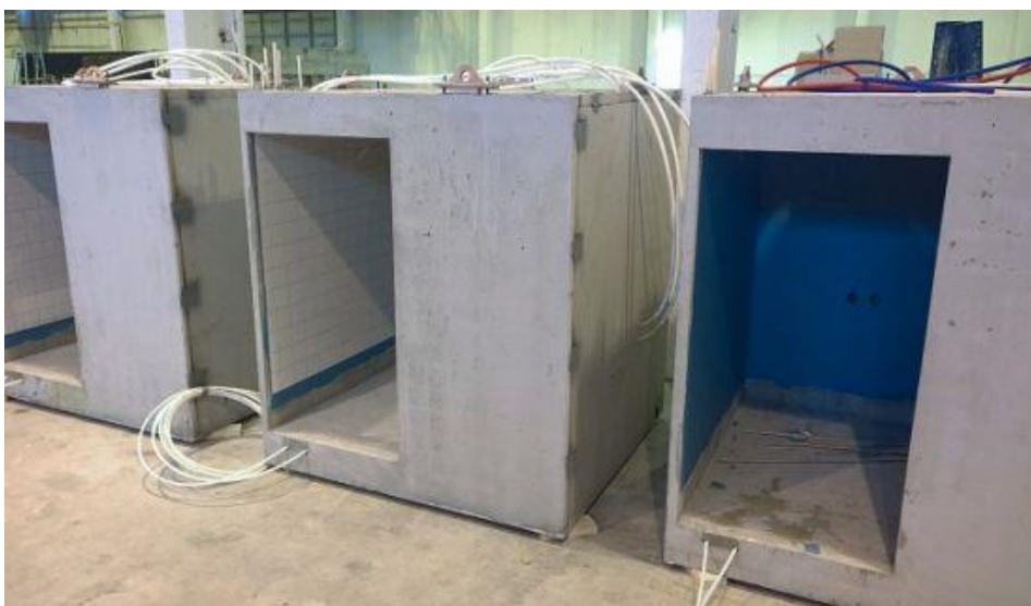
Figura 4 Todos os processos de fabricação, incluindo canalização e instalação elétrica, são realizados industrialmente e em um ambiente de fábrica controlado.
