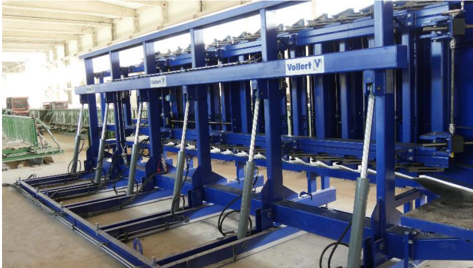
Figura 1 Encofrado hidráulico para escaleras KOMBISTEP en Limelog, Hungría.
