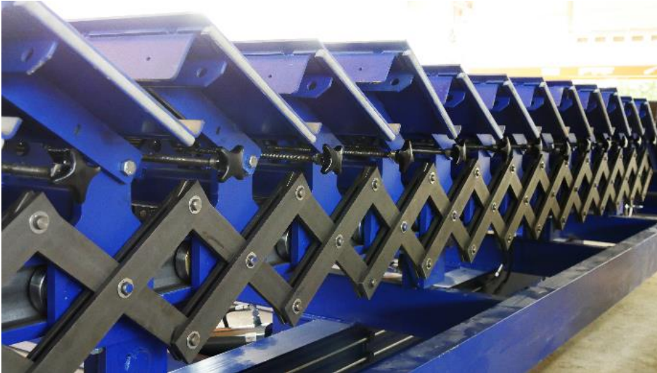
Figura 3 Los escalones también se ajustan hidráulicamente mediante un mecanismo de cizallamiento.
