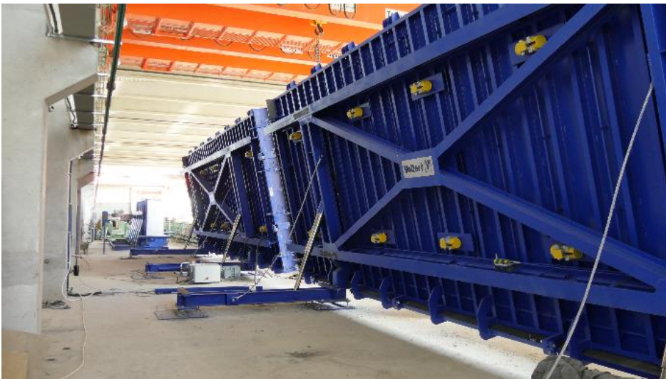
Figura 4 Las nuevas mesas basculantes estacionarias de alto rendimiento de Limelog permiten la producción flexible y horizontal de prefabricados de hormigón de hasta 4 m de anchura y 12 m de altura.
