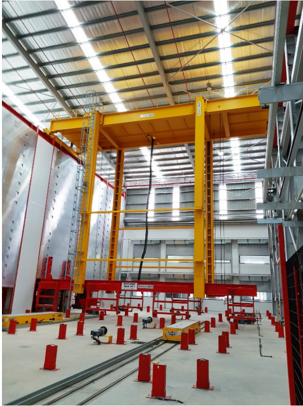
Figura 5 Um robô de armazenagem VARIO STORE assume o armazenamento e retirada eficiente dos elementos de concreto semiacabados para o processo de cura.
