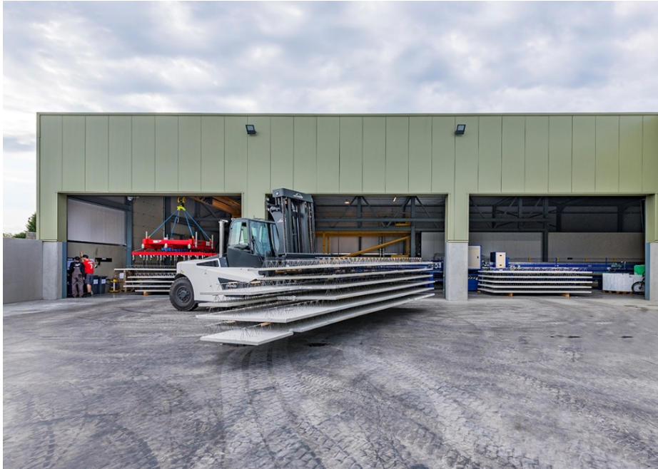
Фото 9 Отгрузка сборных перекрытий на стройплощадку.
