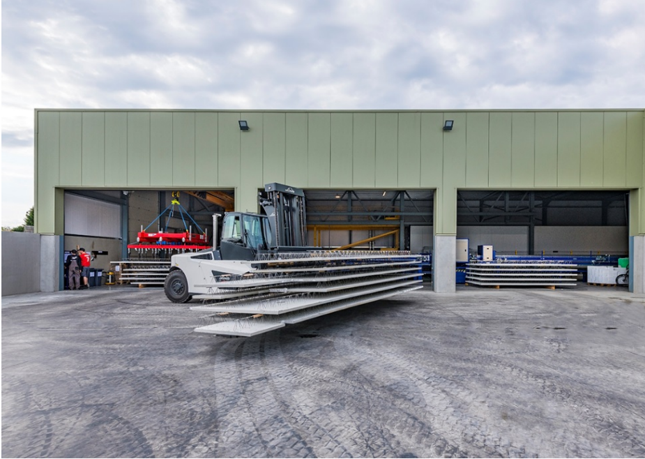
Figura 9 Los elementos de entrepiso son transportados a la obra.
