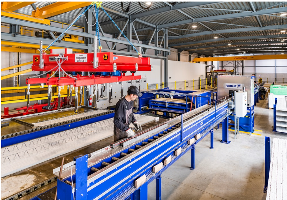
Figura 8 Suciedad y restos de hormigón son retirados de perfiles de encofrado.
