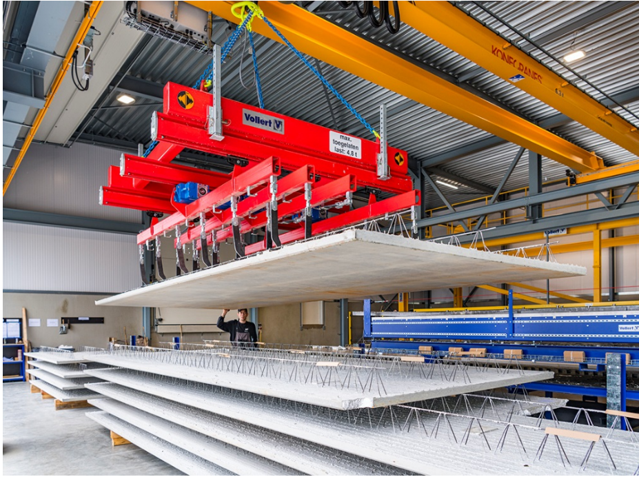
Figura 7 Después del proceso de curado completo, una viga elevadora SMART LIFT retira las losas para cargarlas y transportarlas al cliente.
