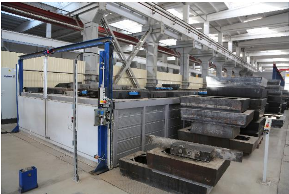
Figura 4 A parede sanduíche se desloca por um túnel isolado de cura intermediária diretamente após o segundo processo de concretagem.
