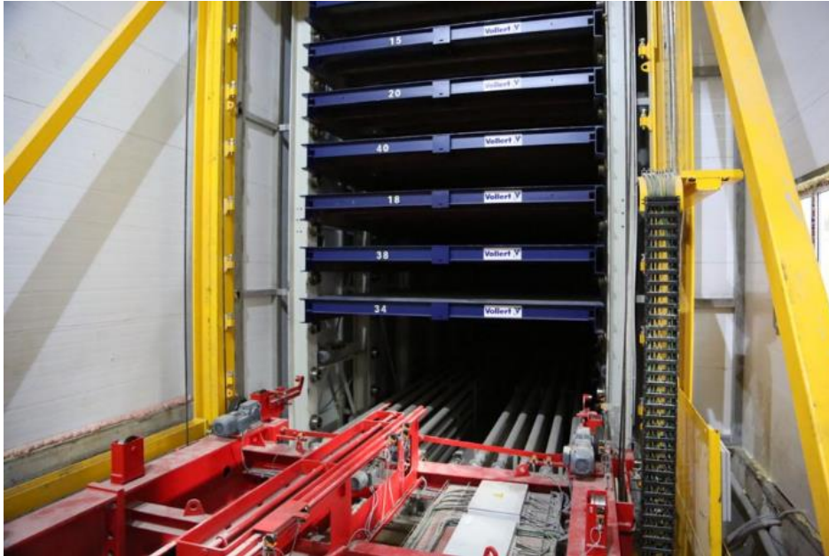
Figura 7 Mediante un sistema especial de acoplamiento, las bandejas de circulación se transportan en parejas a través de las torres de estanterías.
