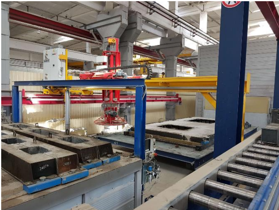
Figura 8 Una alisadora eléctrica VARIO SMOOTH se mueve en direcciones longitudinal y transversal, garantizando una superficie exterior bien lisa.
