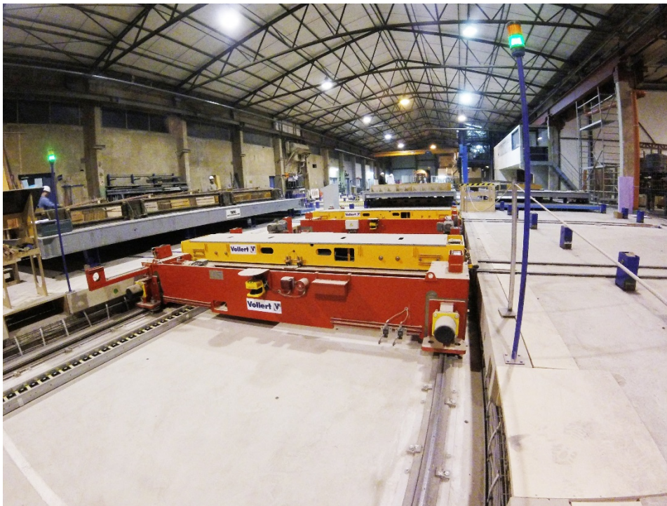
Figura 4 El corazón de la instalación: una plataforma corredera central que puede desplazarse 60 m.
