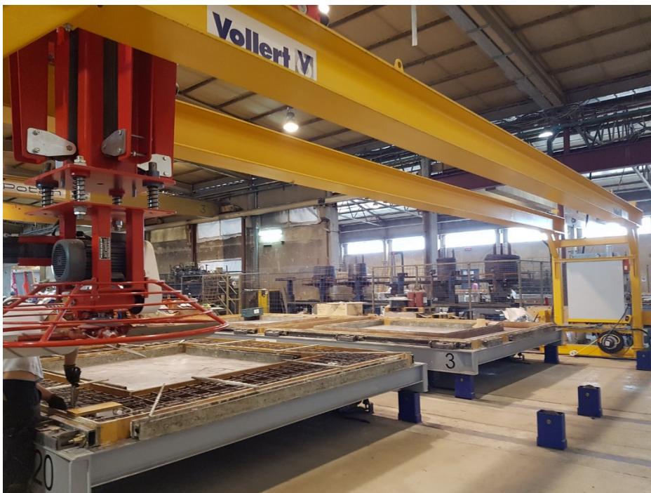
Figura 6 Estación de alisado de hormigón como estructura de pórtico para las superficies de hormigón visto y la calidad Premium requerida.
