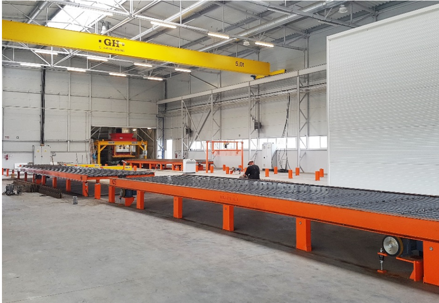
Figura 3 O comprovado princípio de circulação Vollert de produção de peças maciças e semiacabadas foi transferido para a fabricação de lajotas TERIVA.
