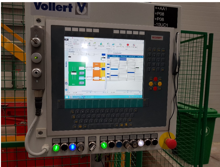
Figura 6 O sistema de controle de produção e armazenagem MES controla e analisa todas as estações de trabalho e os processos da fábrica.
