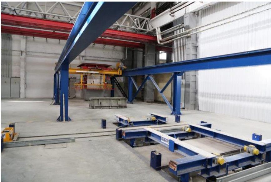
Рис. 5: Виброплощадка Vario COMPACT создает оптимальную верхнюю оболочку массивных бетонных изделий с качеством лицевого бетона
