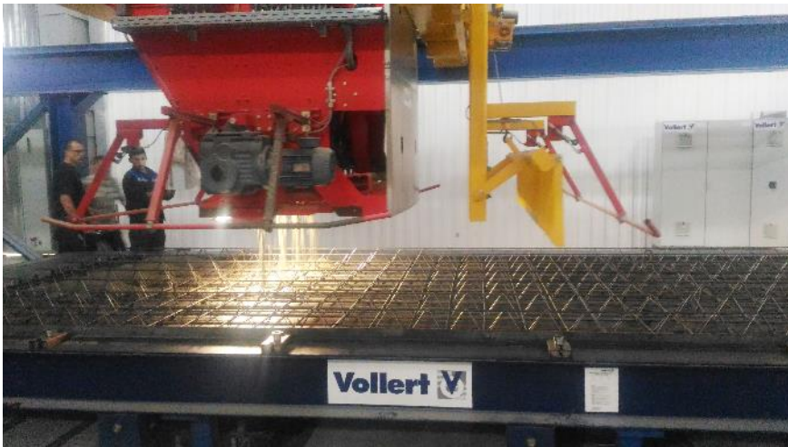
Рис. 4: Количество укладываемого бетона и скорость шипованного вала бетонораздатчика оптимально настраиваются под различную консистенцию бетона
