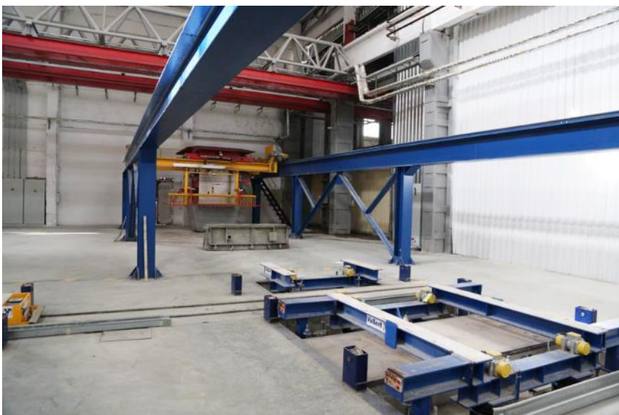
Fig. 5: Uma estação de vibração VARIO COMPACT garante uma superfície dos elementos de concreto maciço com qualidade de concreto aparente
