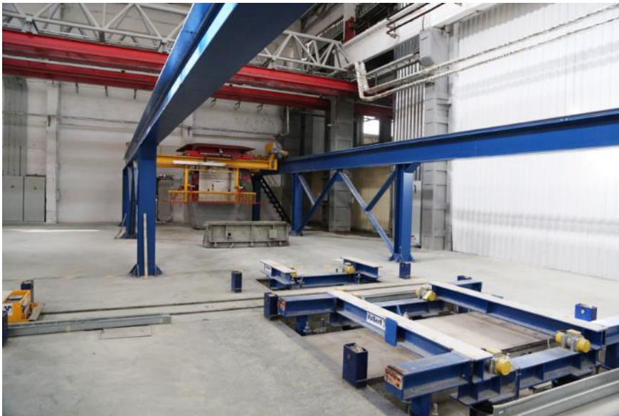
Fig. 5: Una estación vibratoria Vario Compact proporciona una superficie óptima de los elementos de hormigón macizo en calidad de hormigón visto
