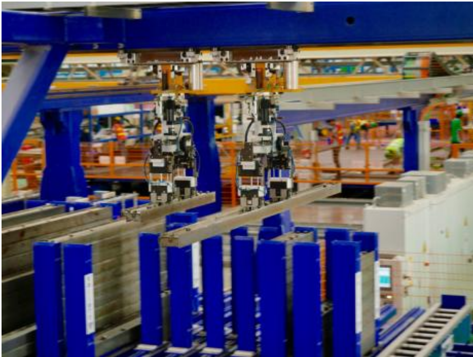
Fig. 1: Un robot de almacenamiento con pinzas gemelas realiza un proceso simultáneo de colocación y extracción
