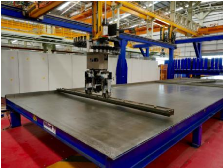
Fig. 2: El trazado previo del contorno y el posicionamiento de los sistemas de encofrado se realizan a través de un control CAD/CAM de un robot de encofrado SMART SET
