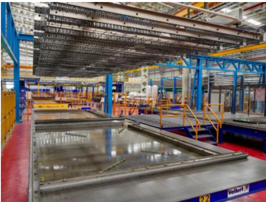
Fig. 4: Las mallas de armadura, como también las armaduras de celosía, son colocadas por una instalación de armadura AWM completamente automática
