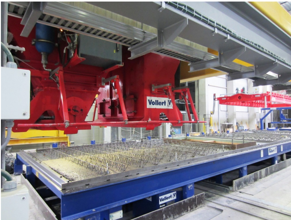
Fig. 4: Uma autêntica novidade é a caçamba de concreto dupla. Deste modo, para além de concreto normal também é possível aplicar concreto aparente colorido.
