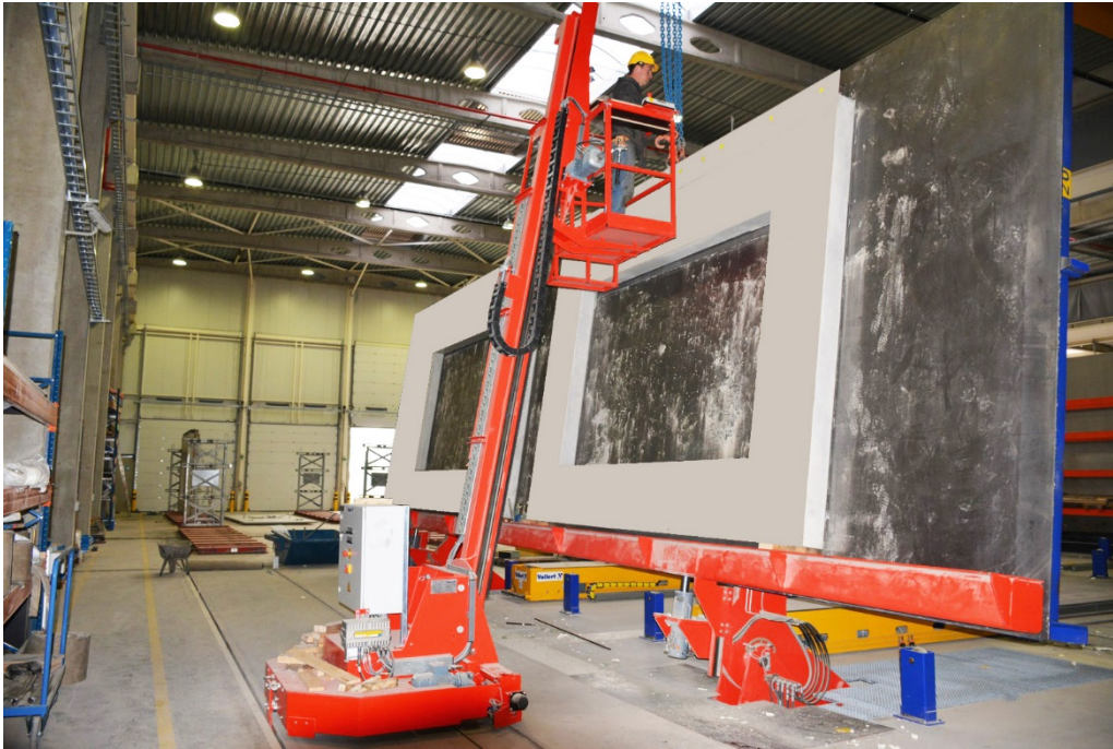
Fig. 7: A elevação vertical dos elementos maciços e semifinalizados é feita por uma estação basculante de alto desempenho VARIO TILT
