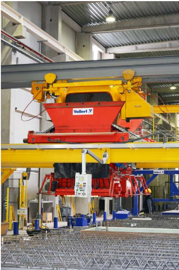
Fig.3: Alimentado por uma caçamba transportadora rotativa, um distribuidor de concreto automático SMART CAST ultramoderno assegura uma descarga homogênea e precisa do concreto
