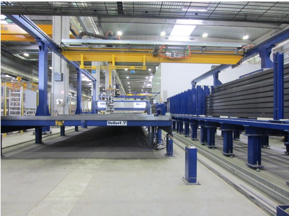
**Fig.2:** Un robot de coffrage SMART SET<sup>2</sup> positionne minutieusement et rapidement les profils de décoffrage Ratec sur la planche de support
