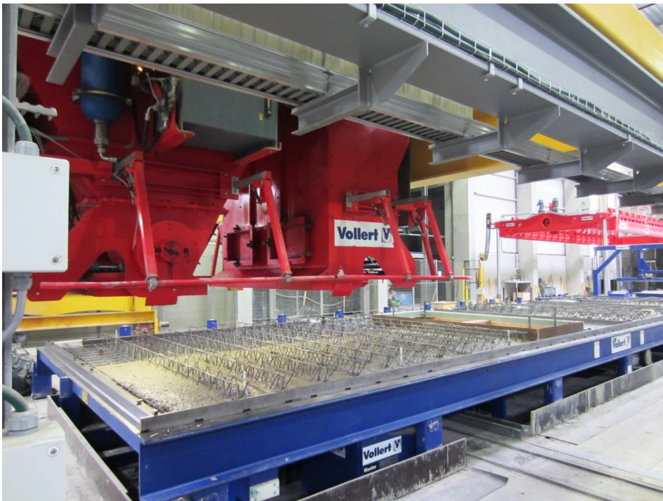
Fig. 4: Una auténtica novedad es la cuba aérea Twin. De este modo, además de hormigón normal, también se puede colar hormigón visto coloreado.
