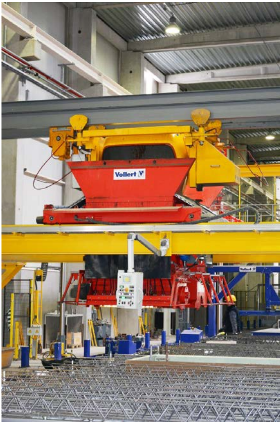
Fig.3: Alimentado a través de una cuba aérea giratoria, un distribuidor de hormigón automático SMART CAST ultramoderno proporciona un colado homogéneo y preciso del hormigón
