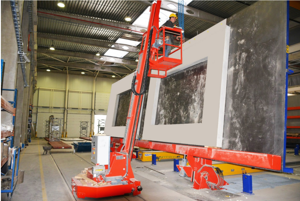
Abb. 7: Das vertikale Abheben der Massivbeton- und Halbfertigteile übernimmt eine Vario TILT Hochleistungs-Kippstation
