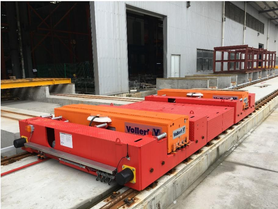
**Fig. 9:** Um carro de elevação vaivém Smart Logistic une a área de carregamento ao local de armazenagem na área exterior
