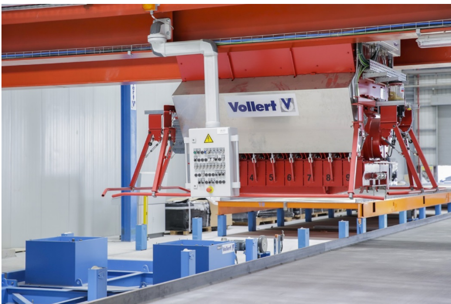
Fig. 4: Le système de pilotage de la production MES génère pour le processus de bétonnage suivant un programme de déplacement optimal.
