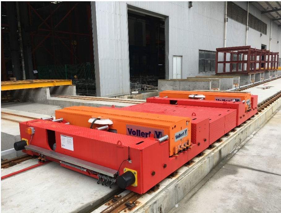
Fig. 9: Un carro elevador de vaivén Smart Logistic comunica la zona de carga con el lugar de almacenamiento en la zona exterior
