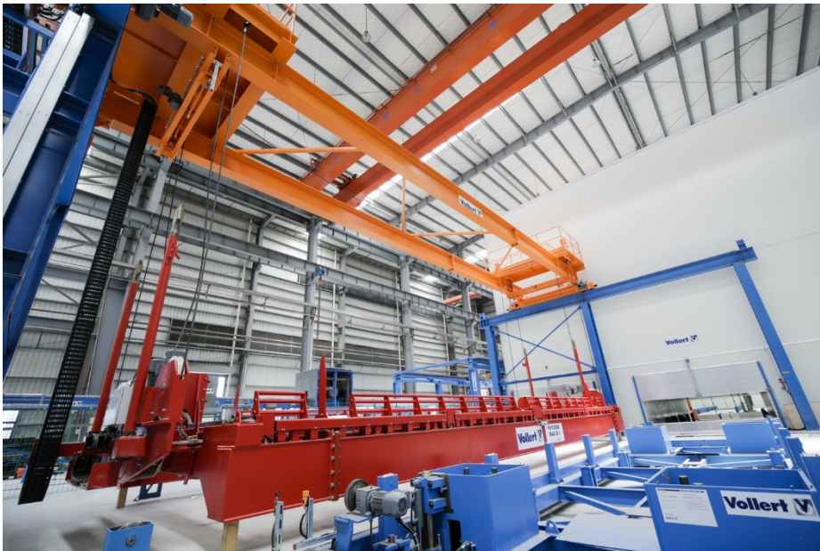
Fig. 6: Equipo de volteo de bandejas Vario Turn altamente moderno y guiado por el techo para la producción de muros dobles
