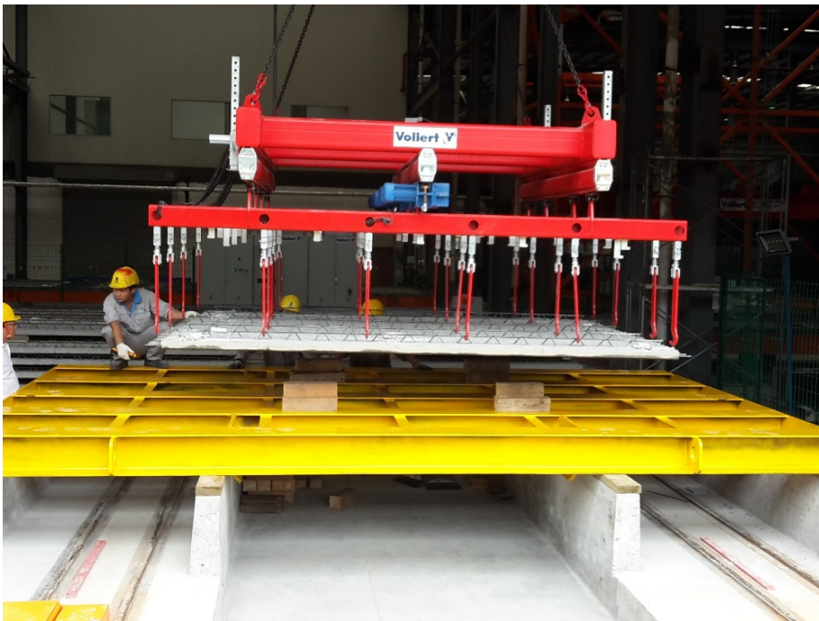
Fig. 8: Las prelas armadas se ponen a disposición horizontalmente en pilas transportables mediante un dispositivo de elevación
