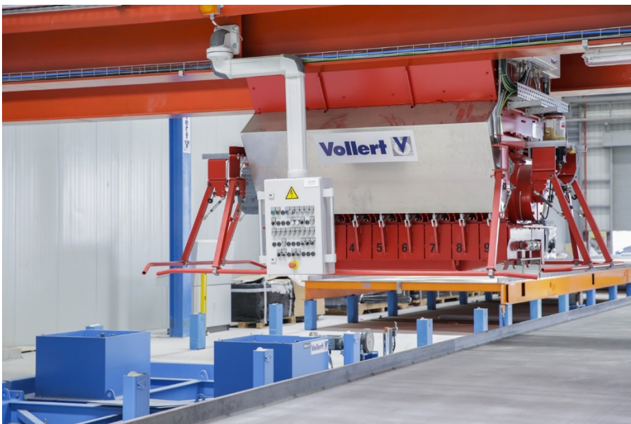
Fig. 4: El sistema de control de la producción MES genera un programa de desplazamiento óptimo para el siguiente proceso de hormigonado
