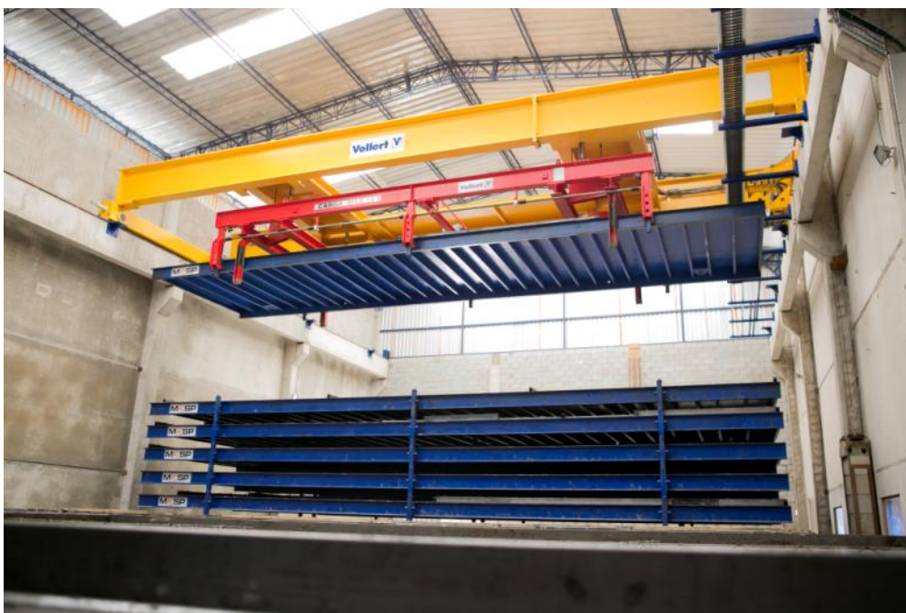
Fig. 4: Rien qu'avec le processus de durcissement moderne, les temps de cycle entre le coulage et le décoffrage sont considérablement réduits
