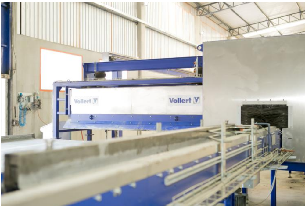
Abb. 6: Bandejas y perfiles de encofrado limpios a través de modernos sistemas de lavado
