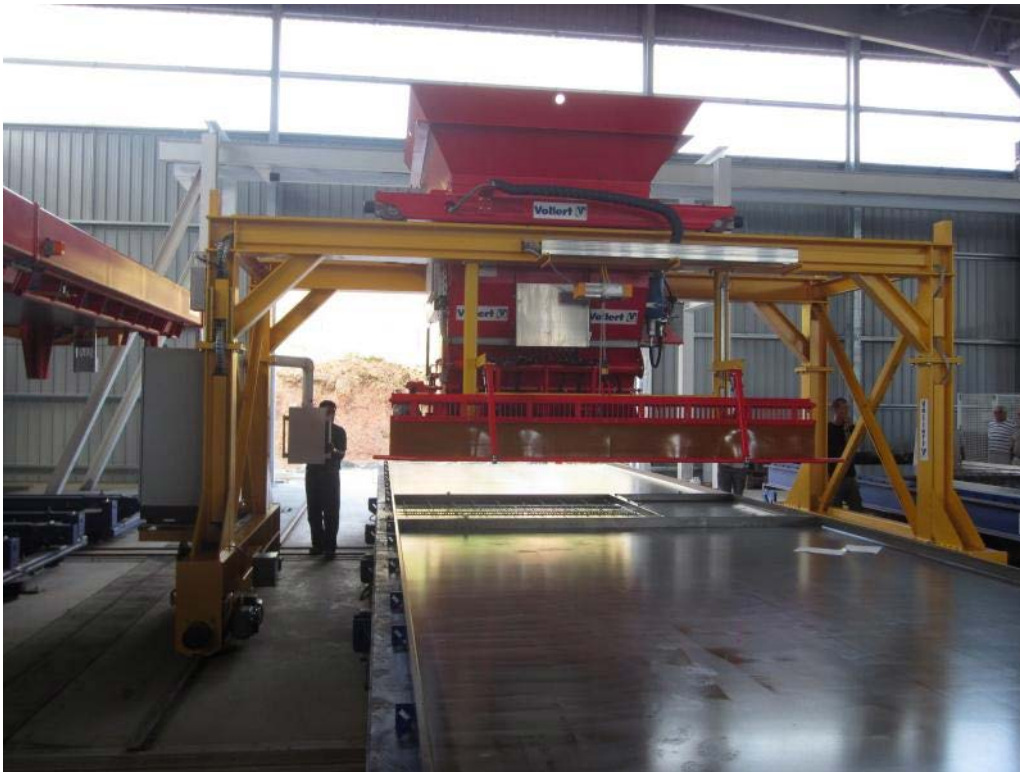
Fig. 5: В силу ограниченного пространства был выбран мостовой бетонораздатчик на рельсовом ходу, обслуживаемый поворотным кубельным транспортером
