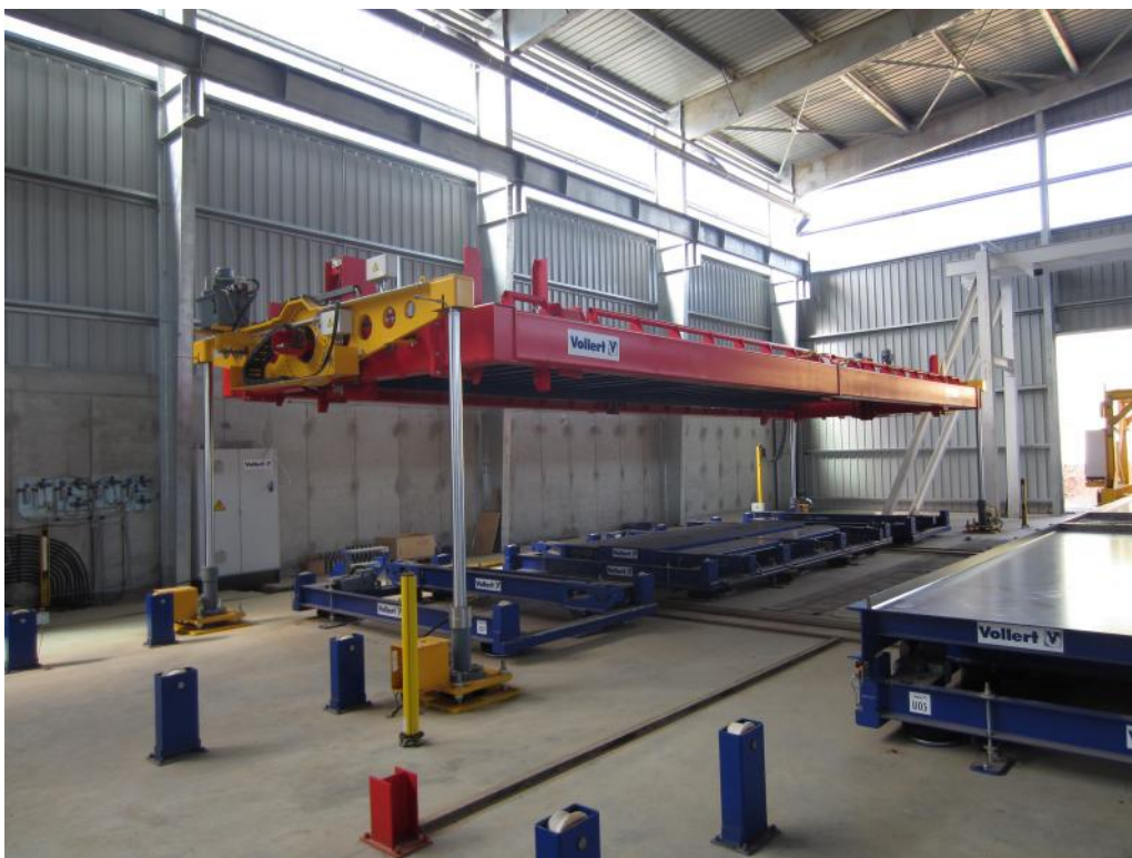
Fig. 7: Производство двойных стеновых панелей на стационарном кантователе поддонов
