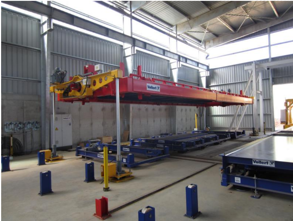
Abb. 7: Production de double paroi avec dispositif de retournement de palettes statique
