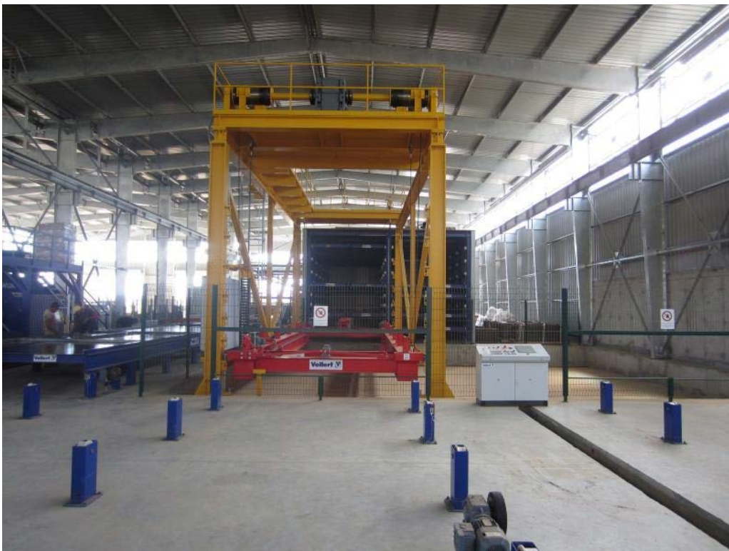
Fig. 6: Un transelevador guiado por el suelo, concebido para una carga superficial del elemento de hormigón de 400 \text{ kg/m}^2 , se encarga de introducir y extraer las bandejas de un modo completamente automático
