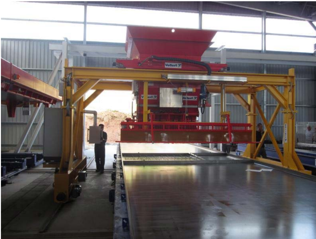
Fig. 5: Debido a la alimentación mediante una cuba aérea giratoria y a las condiciones de espacio muy reducidas se eligió un distribuidor de hormigón sobre carriles con un diseño constructivo tipo puente
