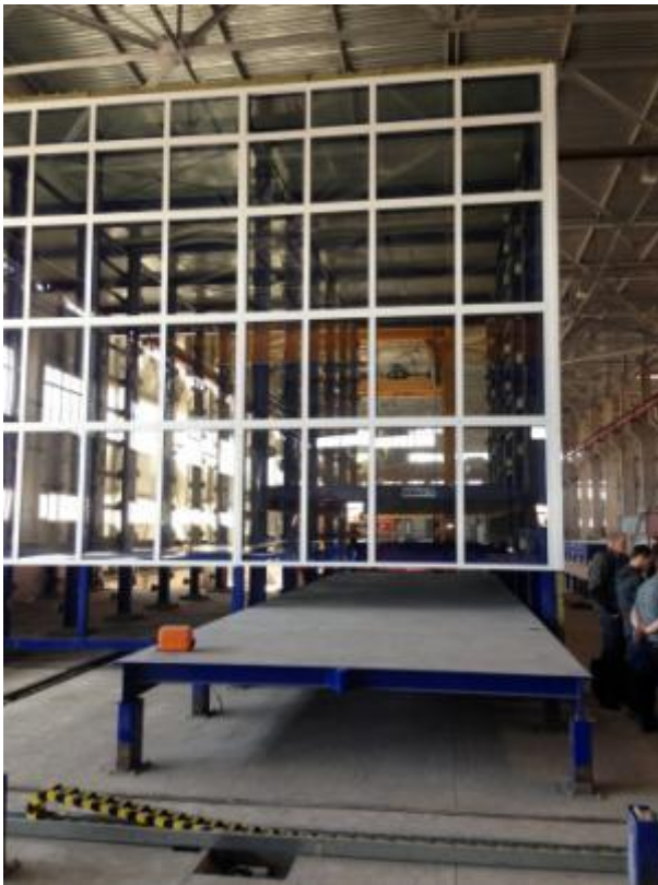
Fig. 6: La chambre de durcissement chauffée se compose de tours de rayonnages fermées en verre athermique
