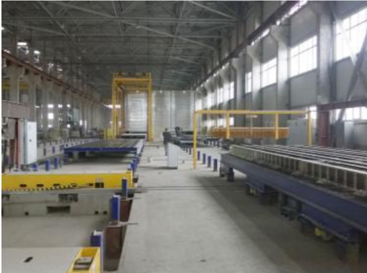
Fig. 3: Pour la fabrication de parois sandwich, la société Vollert a développé des déroulements spéciaux et mise sur une technique de transport transversale intelligente
