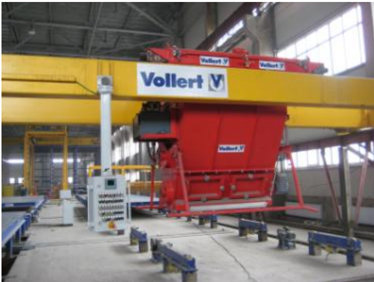
Fig. 4: Un distributeur de béton partiellement automatisé répartit le béton avec une très grande précision et uniformité
