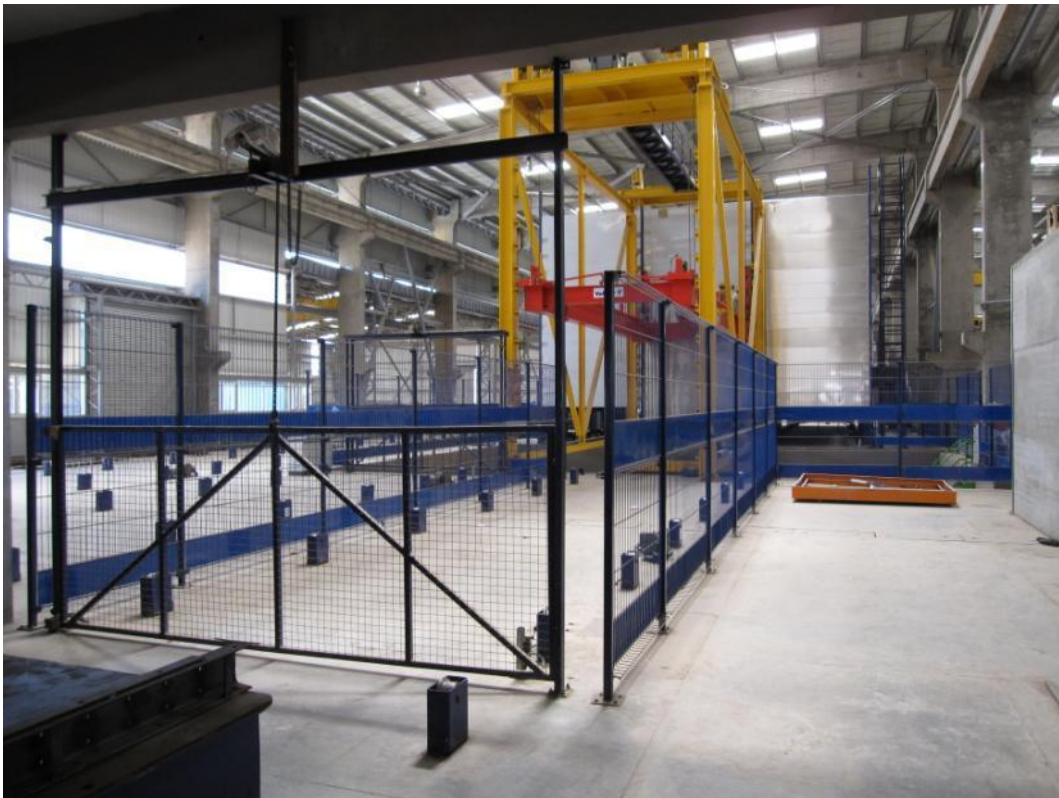
Fig. 14: Камера выдержки состоит из трех стеллажных башен по 14 ярусов каждая
