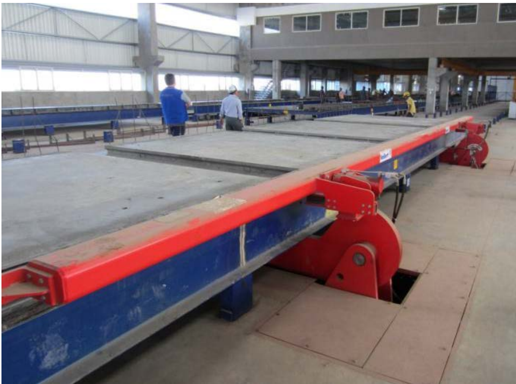
Fig. 16: Кантовательный стол для съема перекрытий и стеновых панелей
