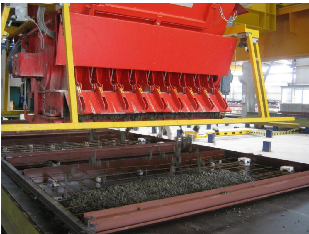
Fig. 8: Descarregamento de concreto fresco na pallet
