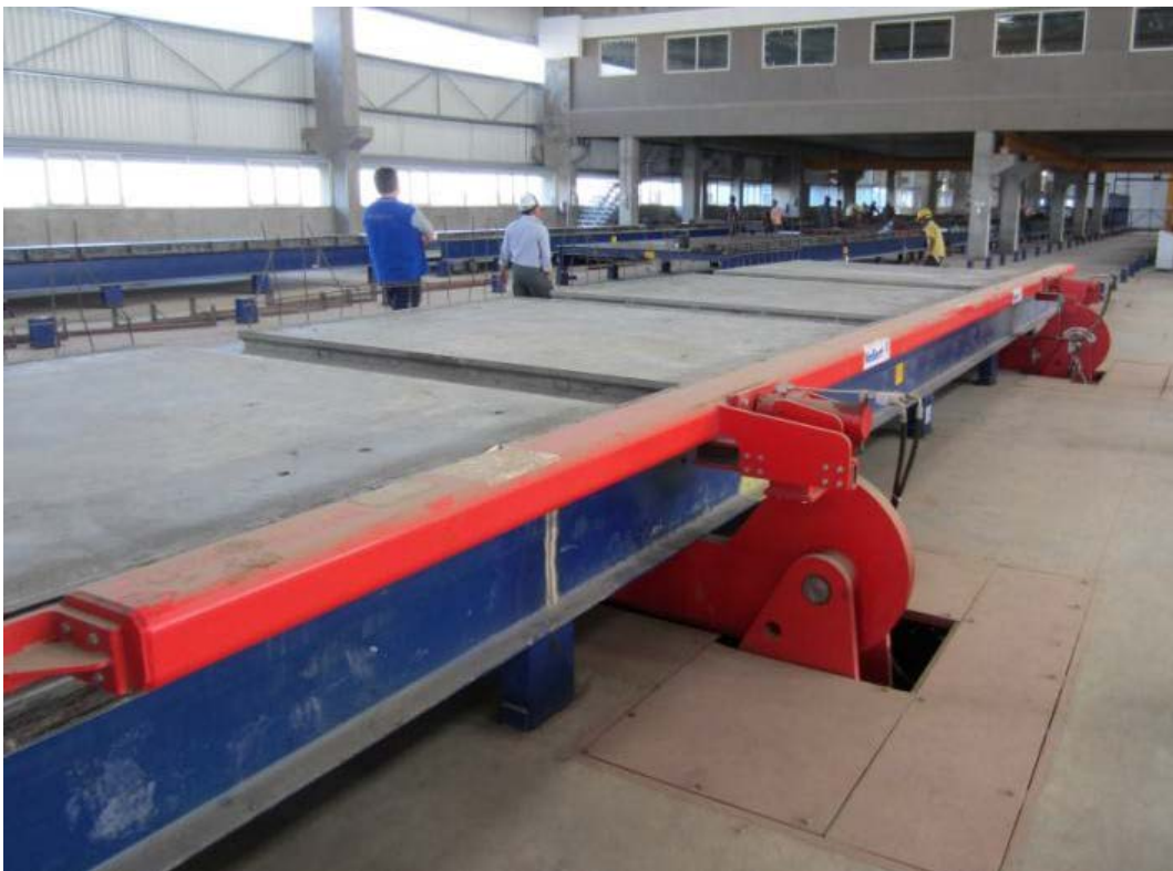
Fig. 16: Mesa basculante para a remoção das paredes sólidas e lajes sólidas
